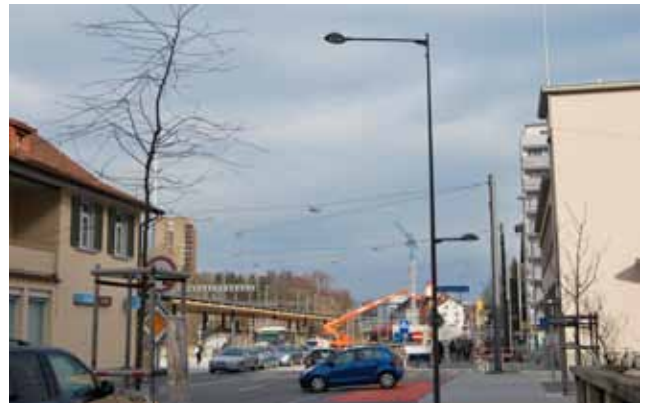
Beispiel: Beleuchtung Gehweg durch Mastansatzleuchten
